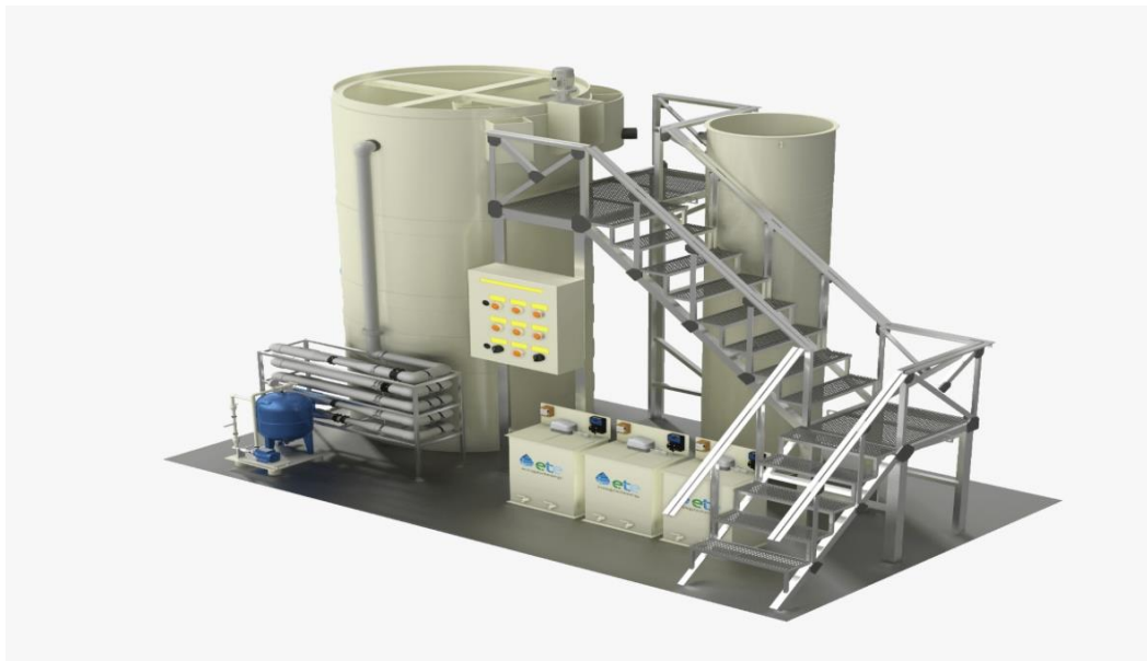
Рисунок 2 – Конструкція станції очищення СВ м'ясопереробних підприємств від компанії «Е.Т.Е» м. Рівне
